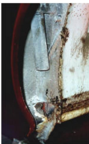
? La gouttière de l'aération tombe pile là où il ne faudrait pas : l'arrière de l'aile avant
