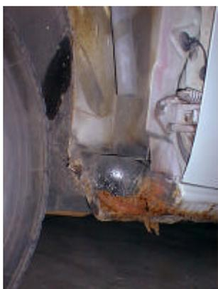
**Bas de caisse :** à l'avant, l'ex-fixation inférieure de l'aile avant. Notons que la gouttière en caoutchouc dirige l'eau vers la partie « sensible ». C'est l'endroit le plus fréquemment endommagé, et bien dissimulé, jusqu'à ce que l'aile rouille à son tour.
