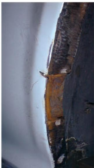
**Ailes arrières :** entre les tôles intérieure et extérieure repliées, il y a une sorte de mousse, insérée pour « étanchéifier » mais qui se révèle être une vraie éponge qui conserve l'humidité : la tôle rouille et gonfle ...
