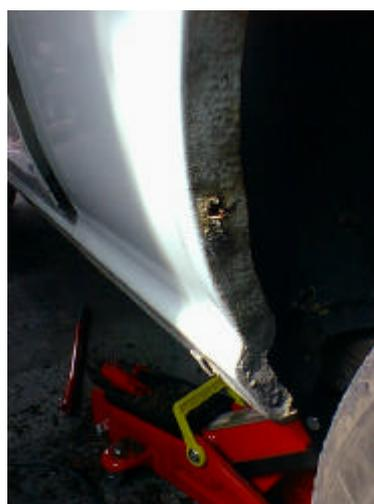
Outre le tour d'aile, il faut aussi jeter un coup d'œil à l'intérieur, où l'on peut trouver, habilement dissimulé derrière les strates de boue, des perforations.
